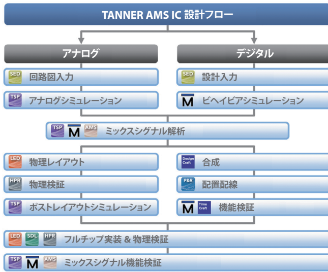
アナログ/ミックスシグナル (AMS) IC 設計のエンドツーエンドの設計フロー
