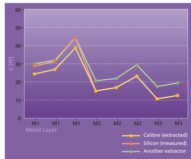
図4: Calibre xRCの寄生抽出結果とテストチップからの測定データの比較
