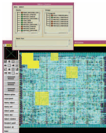
Calibre nmDRCは、エラー領域を識別し変更があったエリアのみを読み込むことにより、サイクル時間を劇的に短縮します。
